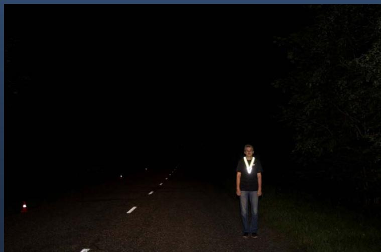
**Выводы:** Пешехода со световозвращателем (треугольным СВ-жилетом) на неосвещенной дороге в ближнем свете фар автомашины хорошо заметно уже со 150 м.
