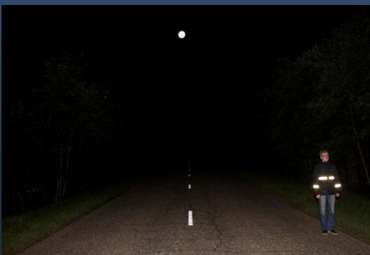
**Выводы:** Пешехода с несъемными световозвращателями (СВ-лентами, нашитыми на куртку) на неосвещенной дороге в дальнем свете фар автомашины заметно более чем с 350 м.
