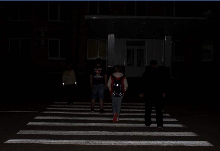
**Выводы:** В зависимости от используемых световозвращателей и места их размещения, пешеходы имеют разную заметность. Одновременное использование браслетов на обеих руках обеспечивает наилучшую заметность со всех направлений наблюдения.
