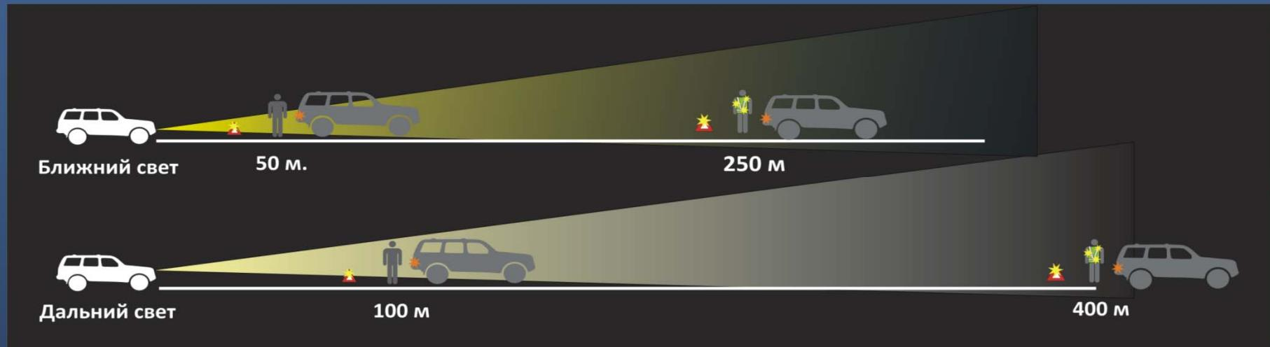
Водителя на неосвещенной дороге около автомашины без световозвращателей практически не заметно. Аварийная сигнализация и знак аварийной остановки в темноте не обозначают самого водителя на дороге.
