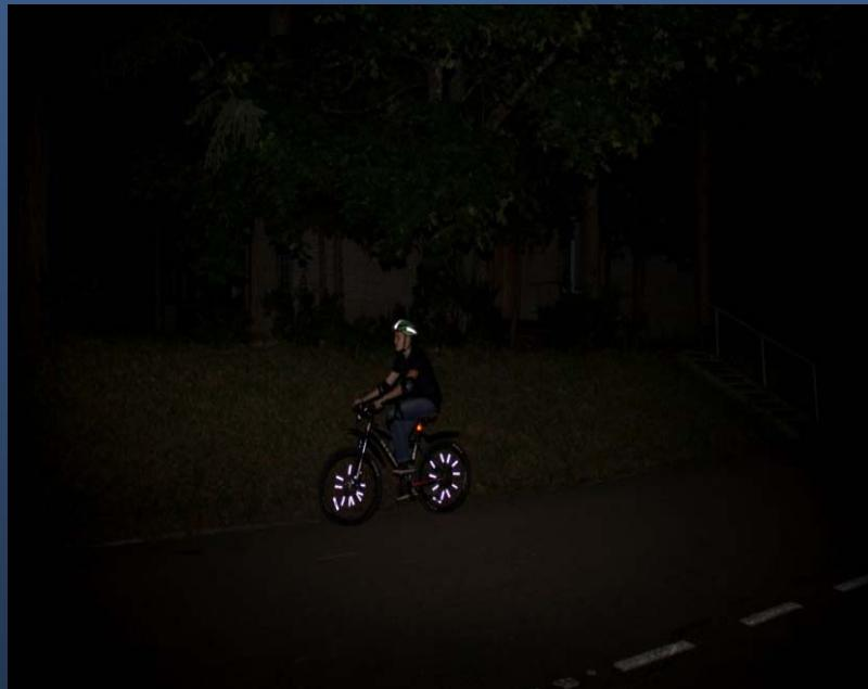
**Выводы :** Такая комбинация световозвращателей делает велосипедиста хорошо заметным только в боковой проекции. Однако спереди и сзади его видимость недостаточна. Частичная оснащенность велосипедиста не обеспечивает необходимую и достаточную заметность его на дороге.
