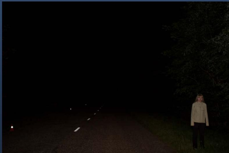
**Выводы:** Пешехода без световозвращающих элементов даже в светлой одежде на неосвещенной дороге в ближнем свете фар автомашины заметно не более чем со 70 м.
