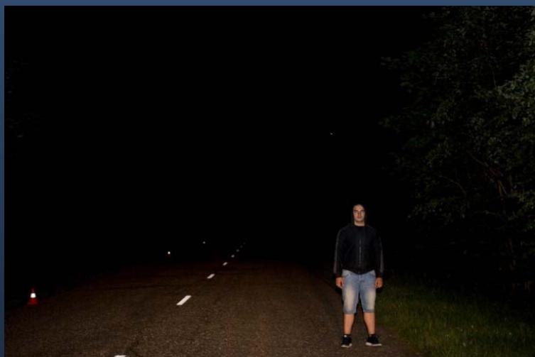
**Выводы:** Пешехода без световозвращающих элементов на неосвещенной дороге в ближнем свете фар автомашины заметно не более чем с 50 м.
