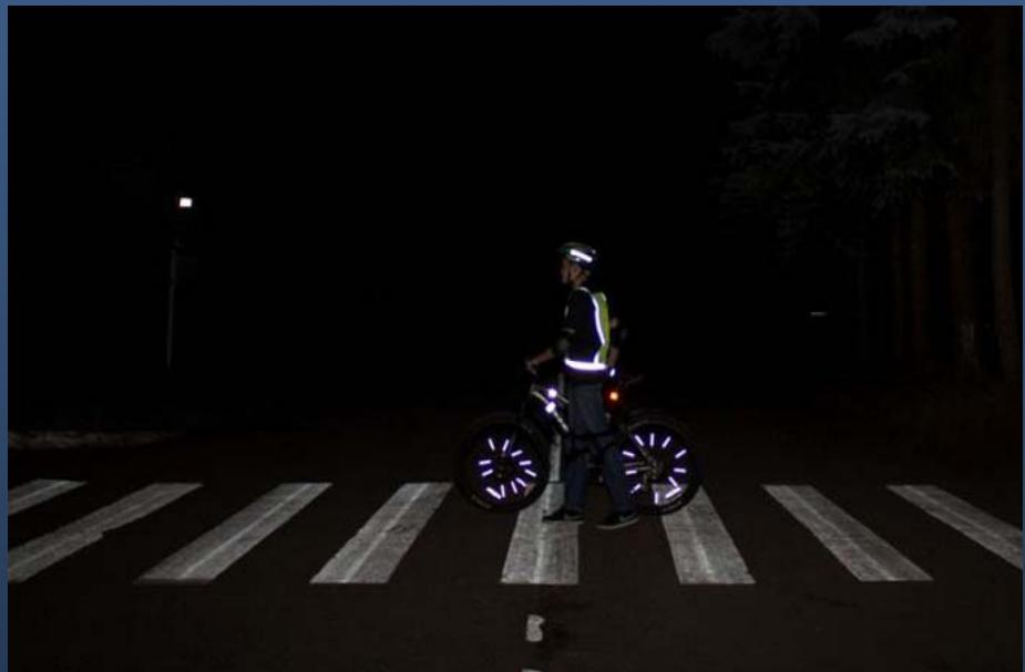
**Выводы:** На приведенных фотографиях хорошо видно, что наличие на велосипеде только стандартных сигнальных средств (катафотов) из-за их малой площади не обеспечивает достаточную заметность в боковой проекции. Использование сигнального световозвращающего жилета и световозвращателей на спицах колес значительно повышает заметность велосипедиста со всех сторон.
